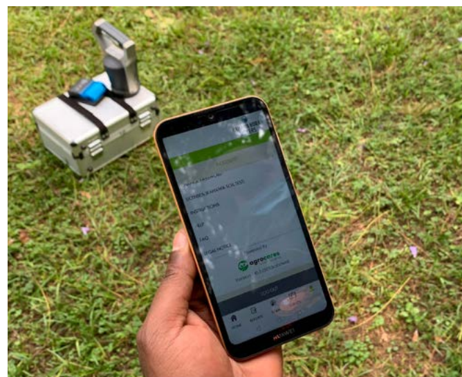
Les scanners de sol électroniques mesurent (sans creuser) la composition et le compactage du sous-sol
