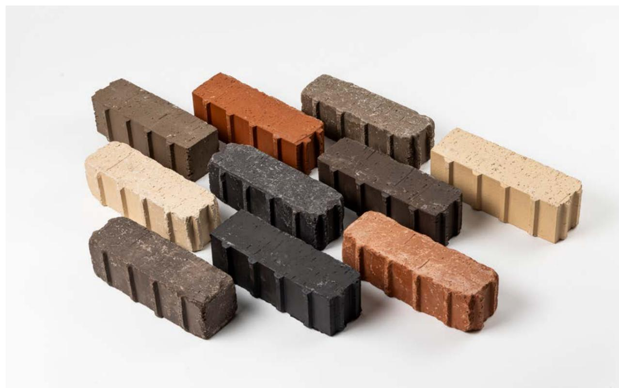
Avec la gamme Passaqua, wienerberger offre depuis longtemps une solution idéale pour concilier le besoin de pavage avec l'obligation d'infiltration locale des eaux de pluie. Grâce à ses écarteurs, le pavé en terre cuite crée, lors de la pose, un joint de 6 mm de large permettant le passage de l'eau. Ainsi, les joints représentent une part de 10 % de la surface totale revêtue. Ce qui constitue le minimum pour être considéré comme un revêtement drainant.
