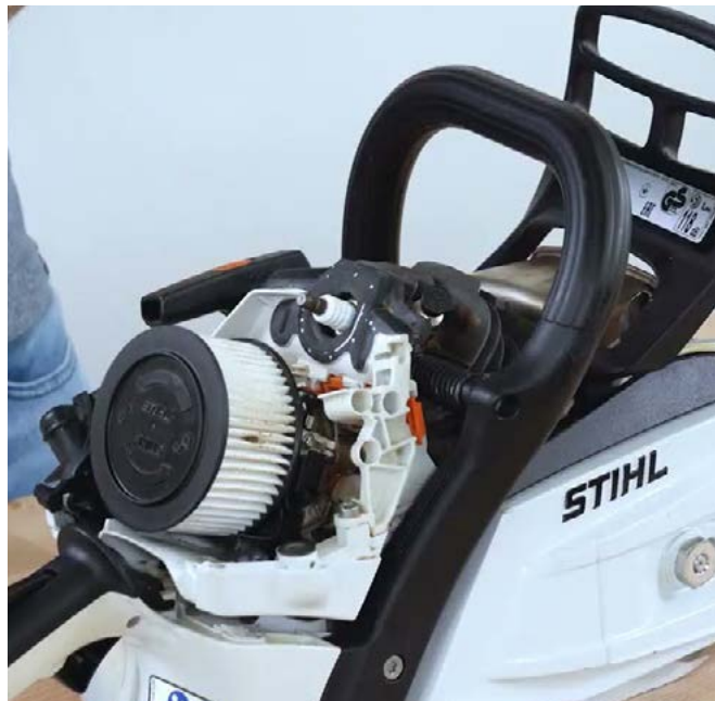
Stihl - En tant qu'élément du système d'allumage, la bougie est essentielle pour le moteur et doit être remplacée régulièrement
