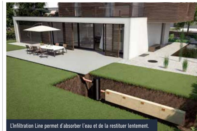
L'Infiltration Line permet d'absorber l'eau et de la restituer lentement.
