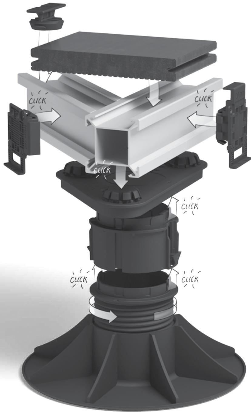
Grâce à sa technologie unique sans vis, le système modulaire Twinson Click permet de gagner du temps lors de l'installation. Le système de clic innovant permet d'assembler l'ensemble de la sous-structure d'une terrasse sans utiliser de vis. Combiné aux planches de terrasse Twinson de Deceuninck, Twinson Click offre l'alternative parfaite à une terrasse en bois.
